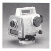
Das erste digitale Nivellier für die Genauigkeiten der Baustelle. Das neue Modell DL-103 bietet Ihnen den Komfort, den Sie bereits von den Baunivellieren von Topcon kennen. Modernste Digitaltechnik wird zum Standard.
