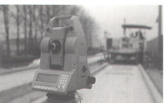
Abb. 2: Einsatz einer automatischen Leica Totalstation TCA1800 zur Führung eines Gleitschalungsfertigers.
