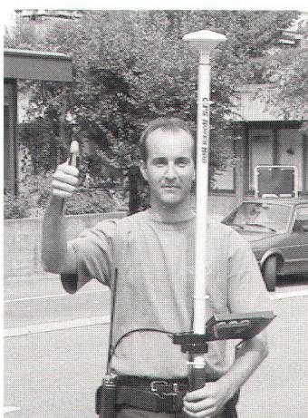
**Zuverlässiger RTK-Einsatz in extremer Umgebung durch Nutzung zweier Satellitensysteme GPS und GLONASS**
