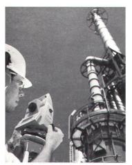
Abb. 2: TCR Instrumente ermöglichen Punktbestimmung und präzise Distanzmessung ohne Prismen bei schwer oder gar nicht zugänglichen Zielen.
