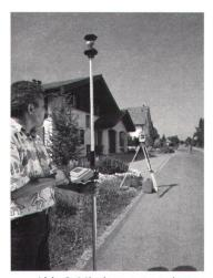
Abb. 3: Mit der neugestalteten RCS1100 Fernsteuerung lassen sich Daten und Zusatzinformationen genau dort erfassen, wo sie anfallen: direkt am Messpunkt. Über Funk kann man sämtliche Funktionen des TCA Tachymeters aufrufen.
