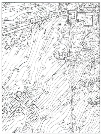
Abb. 5: Eretria in Griechenland, Schweizer Ausgrabungen, Topographie der Akropolis: Nordostecke der Stadtbefestigung; nebst den zahlreichen Mauern und Messpunkten fallen vor allem die Schuttkegel der Ausgrabungen auf; Handriss, Ausschnitt 1:1000, Originalaufnahme im Massstab 1:500.
