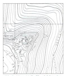
Abb. 8 Mont Vully FR, gleicher Ausschnitt 1:2000 wie Abb. 7: Einmessung der Turmruine mit Bussolentachymetrie und freihändige Überarbeitung der Höhenlinien.
