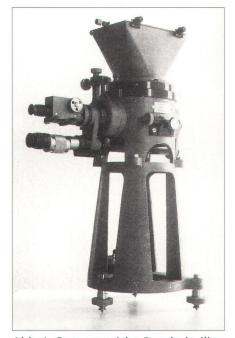
Abb. 1: Gesamtansicht. Der dreiteilige Aufbau ist gut erkennbar: Zuoberst die Kamera, in der Mitte der Messteil, darunter der Fuss mit den Fussschrauben.
