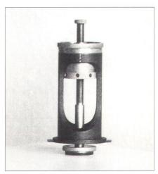
Abb. 3: Zugmechanismus. Es ist der vom A2 her bekannte Mechanismus für die Verschiebung der Objektive zur Korrektur der Abbildungsweite.
