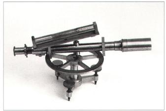
Abb. 7: Nivellier demontiert.
