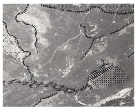
Abb. 2: Orthophoto mit Visualisierung des geologischen Gutachtens (Massenbewegungen).
