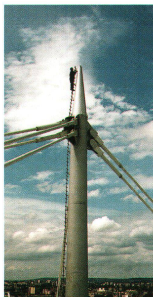
Abb. 6: Bruno Fouché setzte für die Längenbestimmung der Abspannseile den Leica DISTO ein. Mit dem Tachymeter Leica TC1600 wurden Vertikalität der Pylone und Dachstrukturen bestimmt.
