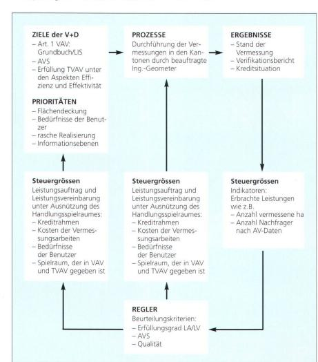
Abb. 3: Controlling-Regelkreis der Amtlichen Vermessung.
