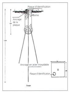
Fig. 2: Schéma de matérialisation d'un point CASA.
