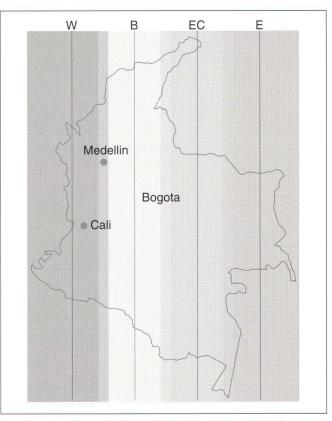
Fig. 4: Projections de Gauss-Krüger avec leur méridien central respectif. Les recouvrements des différents fuseaux sont de 0,5°.
