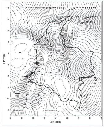
Fig. 3 : Géoïde colombien par rapport à l'ellipsoïde GRS80. Les cotes du géoïde varient entre –25m et 23 m en présentant des variations locales très importantes de l'ordre de 1 m sur 5 kilomètres. Ceci conduit à des pentes maximales supérieures à 20%.
