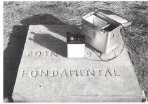
Fig. 2: Photo du gravimètre sur le point fondamental du réseau (GPS 99).
