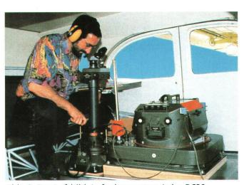
Abb. 2: Das Luftbild-Aufnahmesystem Leica RC30.
