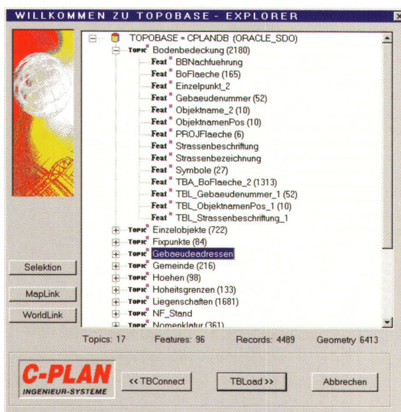
Abb. 2: Zur Auswahl von Topics und Features für die Anzeige in Topobase Explorer erscheint die Datenstruktur in Windows-Manier auf dem Bildschirm.
