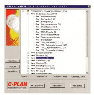
Abb. 2: Zur Auswahl von Topics und Features für die Anzeige in Topobase Explorer erscheint die Datenstruktur in Windows-Manier auf dem Bildschirm.
