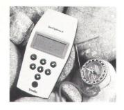
GPS-Technologie. Wird der Pathfinder mit einem DGPS-Korrekturempfänger (z.B. RDS der L+T oder mit einer eigenen Referenzstation) verbunden, können Echtzeit-Genauigkeiten von ca. ±1–3 m erreicht werden. Ca. 9000 dreidimensionale Positionen können mit der standardmässig installierten Software in einem Intervall bis zu 0.7 s registriert werden.
