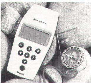
GPS-Technologie. Wird der Pathfinder mit einem DGPS-Korrekturempfänger (z.B. RDS der L+T oder mit einer eigenen Referenzstation) verbunden, können Echtzeit-Genauigkeiten von ca.  $\pm 1-3$  m erreicht werden. Ca. 9000 dreidimensionale Positionen können mit der standardmäßig installierten Software in einem Intervall bis zu 0.7 s registriert werden.
