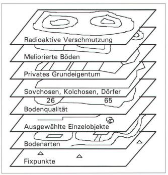
Abb. 2: Struktur und Inhalt des Informationssystems.
