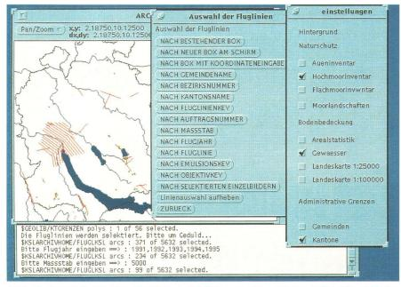
Abb. 5: Darstellung der Fluglinien 1:5000, aus den Jahren 1991 bis 1995 im Kanton Zürich, Hintergrundkarte mit Gewässern und Hochmoorperimeter und Kantonsgrenzen, Möglichkeit eines Zoomfensters für selbstdefinierte Regionen.
