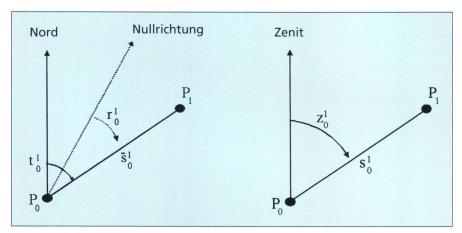
Abb. 2: Horizontale und vertikale Komponente.
