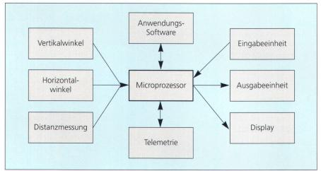
Abb. 4: Einsatz der Totalstation.
