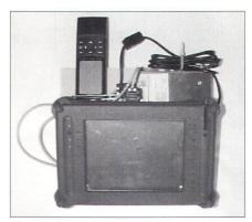
Fig. 4: Station de travail comportant un GPS Garmin 12 XL, un décodeur DCI de corrections différentielles (DGPS de l'OFT) et un pencomputer Kalidor.
