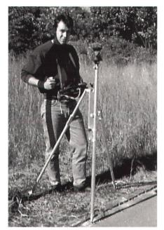
Fig. 2: Principale carctéristique de la «one-man station»: le pilotage du tachéomètre et l'interprétation depuis le point visé.
