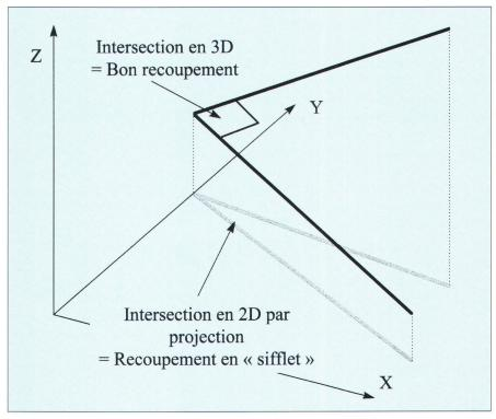
Fig. 7: Conséquences du calcul en 2D par rapport à celui en 3D.
