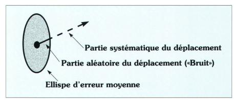
Fig. 8: Les différentes composantes d'un déplacement.
