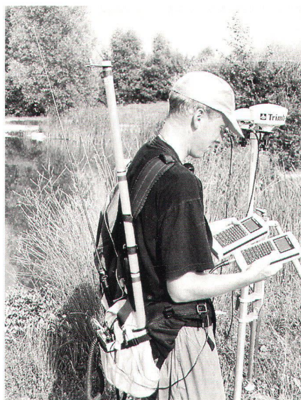
Abb. 1: Zwei Trimble Pathfinder Pro XR während der Testmessungen.
