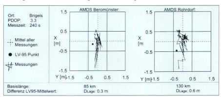
Abb. 3: Plot der 240 Einzelmessungen.
