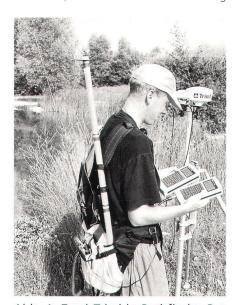
Abb. 1: Zwei Trimble Pathfinder Pro XR während der Testmessungen.
