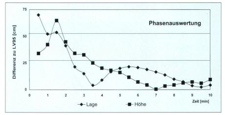
Abb. 5: Differenzen in Abhängigkeit der Messzeit. Basislänge 52 km, Zimmerwald–La Chaux-de-Fonds.
