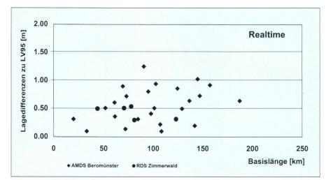
Abb. 4: Lagedifferenzen in Abhängigkeit der Basislänge.
