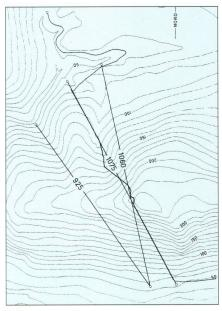
Abb. 2: Das Trassee des Tunnels im Vergleich zu den Alternativlösungen.
