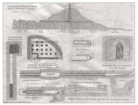
Abb. 1: Der Tunnel des Eupalinos, nach E. Fabricius (1884).
