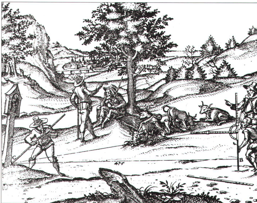
Abb. 3: Indirekte Streckenmessung: Aus Novum Instrumentum Geometricum von Leonhard Zubler, Basel 1625.
