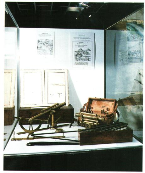
Abb. 9: Vitrine mit zeitgenössischen Vermessungsinstrumenten. Im Vordergrund: Messkette. Einige der Instrumente stammen vom Schaffhauser Messing-Mechaniker und Drechsler Hans Konrad Bartenschlager (1713–1799) (Foto: Dieter Füllemann, Eschenz).
