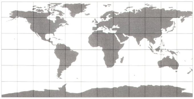
Abb. 2: Quadratische Plattkarte. Längentreue Zylinderabbildung mit dem Äquator als längentreuen Berührungskreis.
