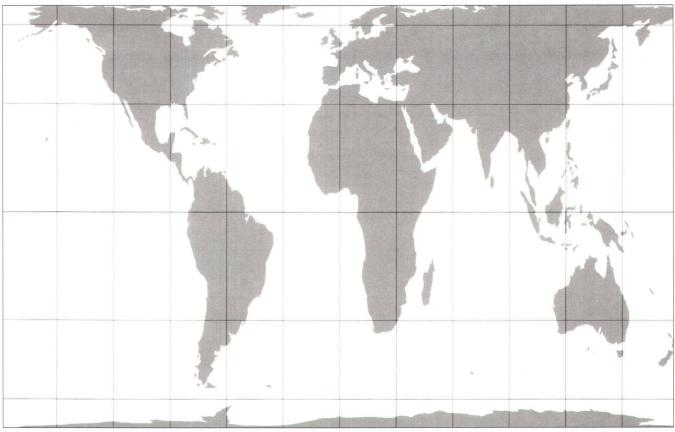
Abb. 1: Flächentreue Zylinder-Abbildung (entspricht in etwa der Petersprojektion) mit längentreuen Parallelkreisen auf 45° 07′ 48″ nördlicher und südlicher Breite.
