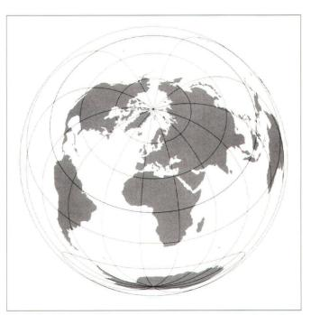
Abb. 5: Flächentreue Azimutalabbildung mit einer Zentrierung auf Punkt  $b_o = 45^\circ$  und  $l_o = 10^\circ$ .
