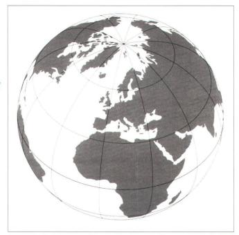
Abb. 4: Orthographische Abbildung (Parallelprojektion) mit einer Zentrierung auf Punkt  $b_{\circ}$  = 45° und  $I_{\circ}$  = 10°. Bei dieser Abbildung liegt der Betrachtungspunkt im Unendlichen. Es kann nur die Hälfte der Erde dargestellt werden.
