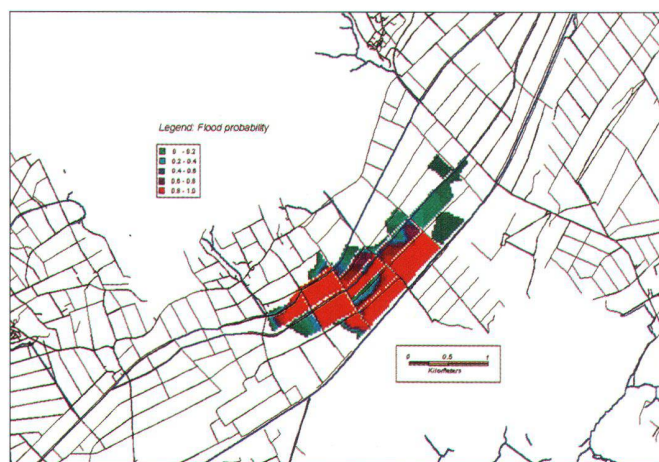
Fig. 2: Exemple de carte diagnostic avec les probabilités de submersion. Cours d'eau de la Petite-Glâne. Périmètre de Missy.
