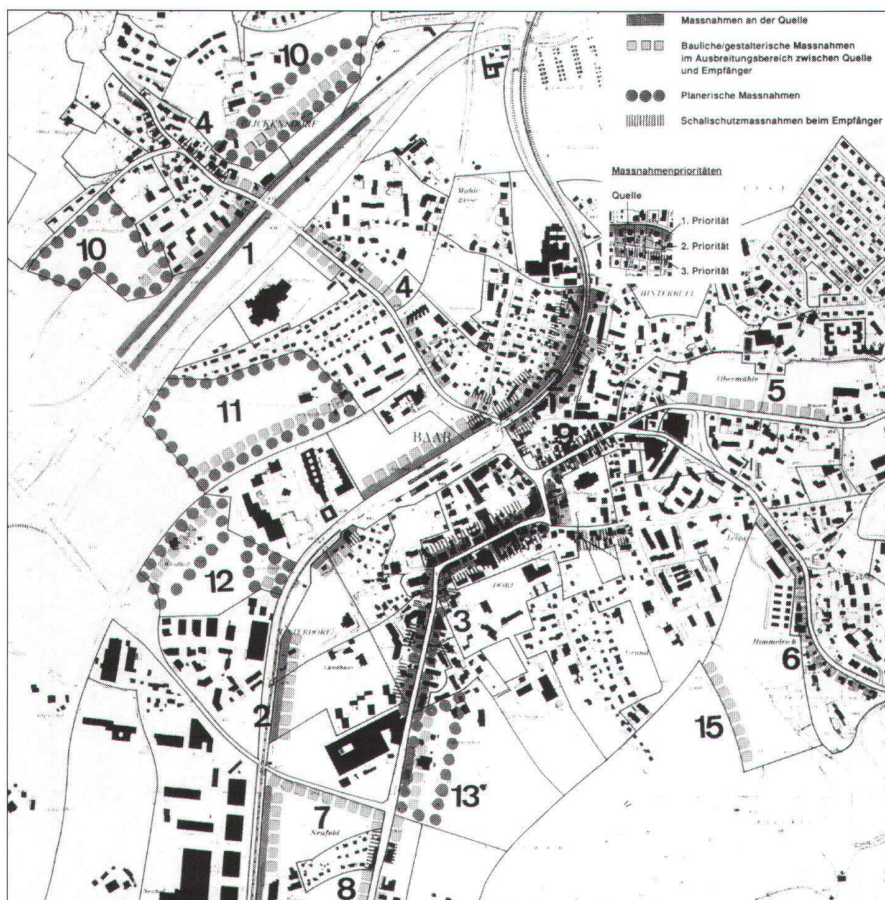
Abb. 1: Massnahmenkonzept (Gemeinde Baar): Massnahmen an der Quelle, bauliche und gestalterische Massnahmen im Ausbreitungsbereich, Schallschutzmassnahmen beim Empfänger.
