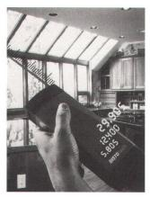
Le nouveau lasermètre portable DISTO basic permet d'effectuer rapidement et à distance des mesures très précises.
