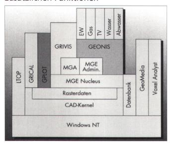
Geonis, ein offenes Informationssystem für kleine und grosse Leitungsnetze unter Windows NT, hat seine Funktionalitäten erweitert. Es besteht aus einem Basismodul für Projektverwaltung und Grundanwendungen sowie spezifischen Modulen für die einzelnen Medien. Die Unterstützung von Flächenobjekten ist neu im Grundmodul implementiert. Netztopologiefunktionen Fangkreisoption im Kanten-Knoten-Modell erlauben eine flexible Datenübernahme aus anderen GIS-Systemen bzw. die Rekonstruktion von Daten.
