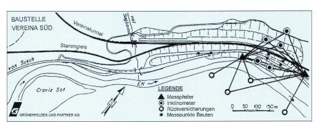
Abb. 7: Stark vereinfachte Situationsdarstellung der Messanlage.
