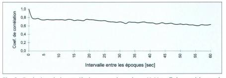
Fig. 3 : Evolution de la corrélation entre les valeurs X, Y ou Z des positions calculées dans une chaîne cinématique, en fonction d'un intervalle croissant entre chaque mesure.
