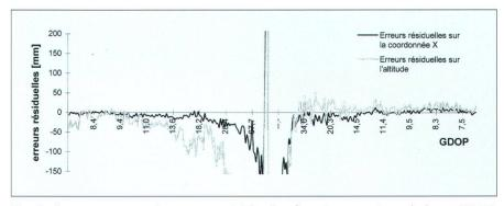
Fig. 2: Comportement des erreurs résiduelles face à une pointe de haut GDOP.
