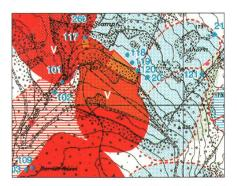
Abb. 8: Quellenkataster: Verwaltet werden sämtliche Wasserfassungen, die öffentlichem wie privatem Zweck dienen. Kombiniert mit Schutzzonen haben die Karten und Pläne eine hohe Aussagekraft.
