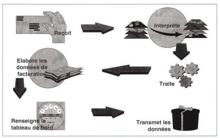
Fig. 4: Les tâches d'un serveur diffuseur de données.
