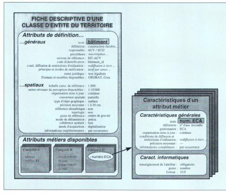
Fig. 3: Exemple d'identification de la classe d'entités «Bâtiment».
