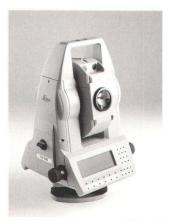
Le tachéomètre Leica TCA est le composant principal de l'option RCS de Leica. Son module de reconnaissance automatique de prismes permet la visée automatique du prisme et la poursuite d'une cible en mouvement.
