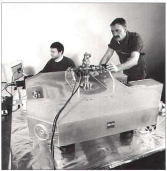
Der von Carl Zeiss in Oberkochen fertiggestellte Ring-Laser-Kreisel – hier beim Abschlusstest – wird in einer unterirdischen Höhle in Neuseeland aufgestellt werden, um sehr präzise die Schwankungen der Erdrotation zu messen.
