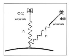
Fig. 1: Mesure de variation de distance.
