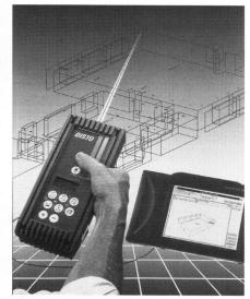
DISOFTmini das komplette «Ein-Personen-Messsystem» mit DATA DISTO, Penpad mit DISOFTmini-Software, Tragegestell und Verbindungskabel.
