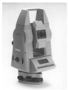
Der TC600 ist ein elektronischer Tachymeter für Kataster- und Ingenieurvermessung, topographische Vermessung und Bauvermessung. In der neuen Version bietet er weitere integrierte Applikationsprogramme und neu Code-Funktionen.
