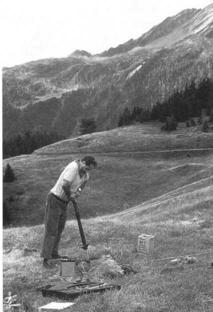
Abb. 7: Einsatz des dynamischen Stabilitätsmessgerätes (nach Pavoni).
