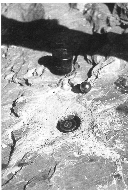
Abb. 9: Kappenbolzen als typische Kennzeichnung eines LV95-Punktes.
