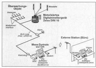
Abb. 1: Solexperts GeoMonitor Datenerfassungs- und Überwachungssystem.
