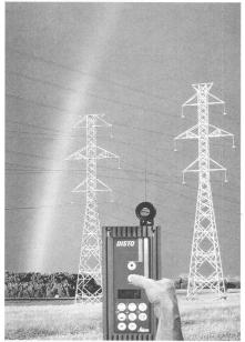
Leica Power Disto permet de déterminer les hauteurs de lignes à courant fort.
