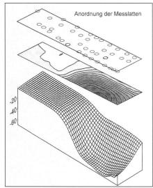
Abb. 4: 3D-Modell und Höhenkurvenbild der Setzungen im S-Bahnhof.
