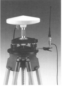
Geodätische GPS-Antenne mit Datenfunk des GePoS RM 24.
