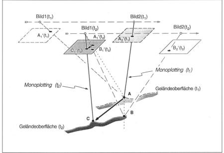
Abb. 6: Mono- und multitemporale Stereomodelle und Bewegungsmessung durch simultanes Monoplotting.
