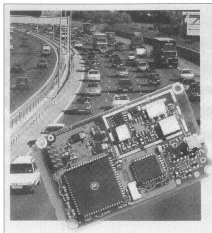
über dem Vorgängermodell VP Oncore eine wesentliche Leistungssteigerung bei tieferen Kosten erlaubt. Erstakquisitionszeiten liegen beim GT Oncore unterhalb 15 Sekunden (Hot Start). Dies ist eine Verbesserung gegenüber der VP Ausführung um 30%. Der Kaltstart (Cold Start) wurde rund 6fach verkürzt und dauert nur noch 90 Sekunden. Mit diesen Werten erfüllt das neue Modul eine Grundvoraussetzung für mobile Anwendungen.
