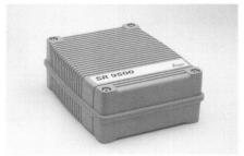
Der neue GPS Sensor SR9500 ist ein geodätischer Empfänger mit zwölf Kanälen und zwei Frequenzen, der perfekt in Leicas GPS Familie System 300 integriert ist. Der Sensor wird mit der externen Antenne AT302 geliefert und kann mit dem Leica GPS Controller CR333 oder CR344 verwendet werden.
