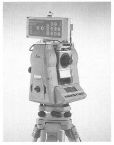
Le qualificatif de «magic meter» du nouveau Leica T460D peut vraiment être pris au pied de la lettre. Combiné au lasermètre Leica Disto GSI, il permet dans le domaine de la construction des mesures sans contact avec laser visible.
