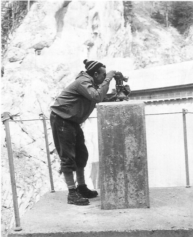
Fig. 1: Observations angulaires de précision avec le théodolite T3.
