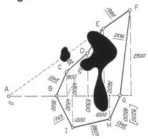
Berechne die fehlenden Aufnahmemasse der Punkte D und E.
