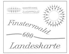
Abb. 13: Textplazierung. Die Böschungsschraffen sind als eigener Font definiert und können entlang von Vektorlinien angeordnet werden.
