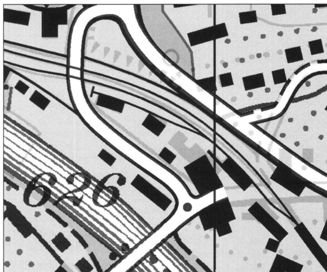
Abb. 10: Hybride Vereinigung der Raster- und Vektordaten mit Darstellung von Überdrucken und Überfüllungen (Bsp. Hauptstrasse). Echte WYSIWYG-Darstellung. Der Stand vor der Nachführung ist unter den neuen Vektoren zu erkennen.
