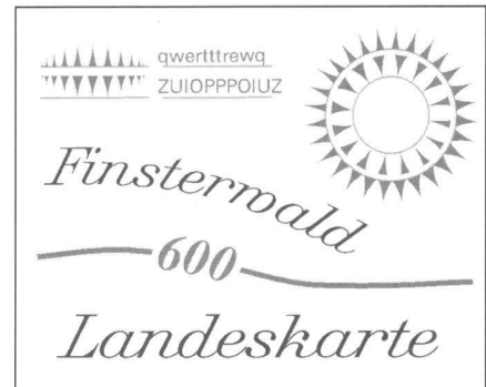
Abb. 13: Textplatzierung. Die Böschungsschraffen sind als eigener Font definiert und können entlang von Vektorlinien angeordnet werden.
