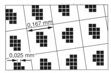
Abb. 2: Prinzip der autotypischen Rasterung (z.B. Wasserfläche als 20% Rasterton mit 60 Punkten/cm aus 0,025 mm Pixeln).
