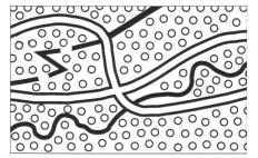
Abb. 7: Regelmässige Flächenmuster wirken unnatürlich und hinterlassen bei einer Maskierung unkontrollierte Fragmente oder Lücken (oben). Erwünscht wäre eine durch Abstände definierte Restfläche, gleichmässig gefüllt mit einem Muster aus zufällig verteilten Signaturen (unten).
