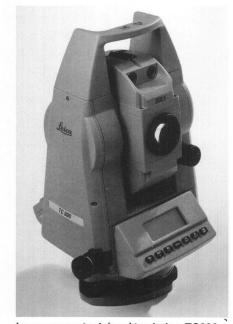
Le nouveau tachéomètre Leica TC800 a une mesure d'angle de précision de 1 mgon (3") et une portée de 2500 m. C'est un instrument d'utilisation simple et fiable, qui apporte bon nombre de solutions dans les mesures cadastrales ou de génie civil.
