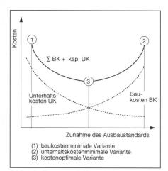
Abb. 4: Bau- und Unterhaltskosten in Funktion des Ausbaustandards (wirtschaftliches Entscheidungsmodell).
