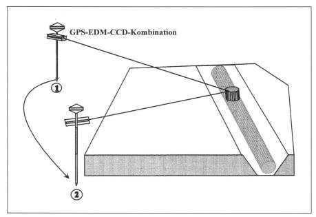
Abb. 2: GPS-Distanzmesser-CCD-Kombination bei der Leitungsaufnahme.
