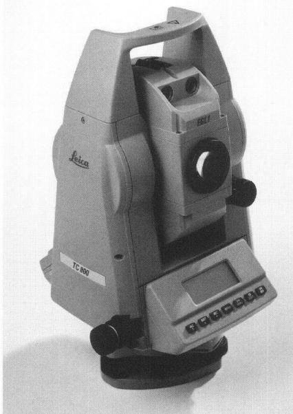
Der neue Leica TC800 Tachymeter mit einer Winkelmessgenauigkeit von 1 mgon ( $3'$ ) und einer Reichweite von 2500 Metern ist für Anwender prädestiniert, die ein einfaches, zuverlässiges und unkompliziertes Vermessungsinstrument zur Lösung von Aufgaben in der Kataster- und Ingenieurvermessung suchen.
